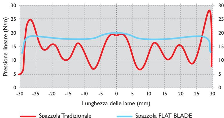
La loro struttura, priva di snodi e di sovrastrutture metalliche, consente una massima resistenza al gelo e il loro adattatore integrato semplifica al massimo l'installazione anche in caso di sostituzione delle spazzole tradizionali.
